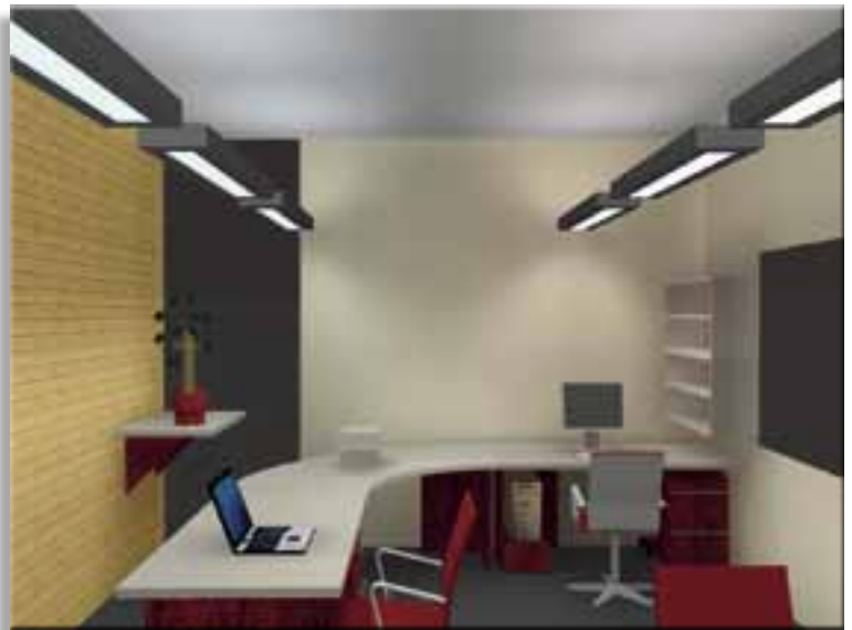
Renderização de luminárias com lâmpadas de 4000K (linha de luminárias à esquerda) e 3000K (linha de luminárias à direita), usando o plug-in de lâmpadas.
